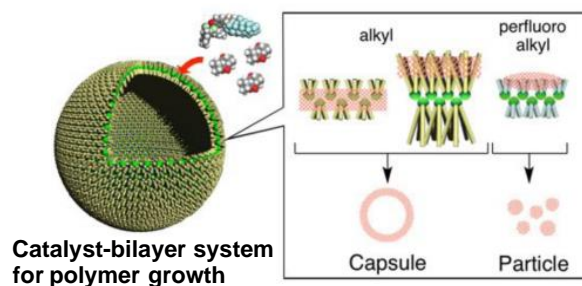
図 3 両親媒性フラレン 1-4 の自己集合により形成する二重膜ベシクルをテンプレートとした、触媒の開環メタセシス反応による重生成物の形態選択的合成
