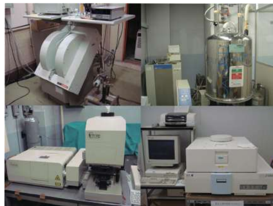
図5. 共通利用装置の一例 (左上)電子スピン共鳴装置 (右下)蛍光X線分析装置 (左下)赤外吸収分光光度計 (右上)核磁気共鳴測定装置 及び赤外顕微鏡
