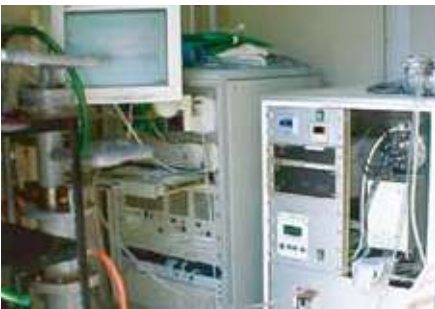
地下水溶存ガス連続測定装置
