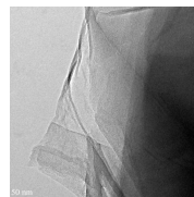
図4. アミノプロピル基を固定化したグラ フェンオキシサイド (AP-GO)のTEM像
