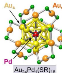
図3 Au 24 Pd 1 (SR) 18 に対して提唱した Pd@Au 12 コアを含む構造。
