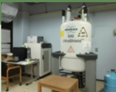
500MHz超電導核磁気共鳴装置 (化学西館2107号室)
